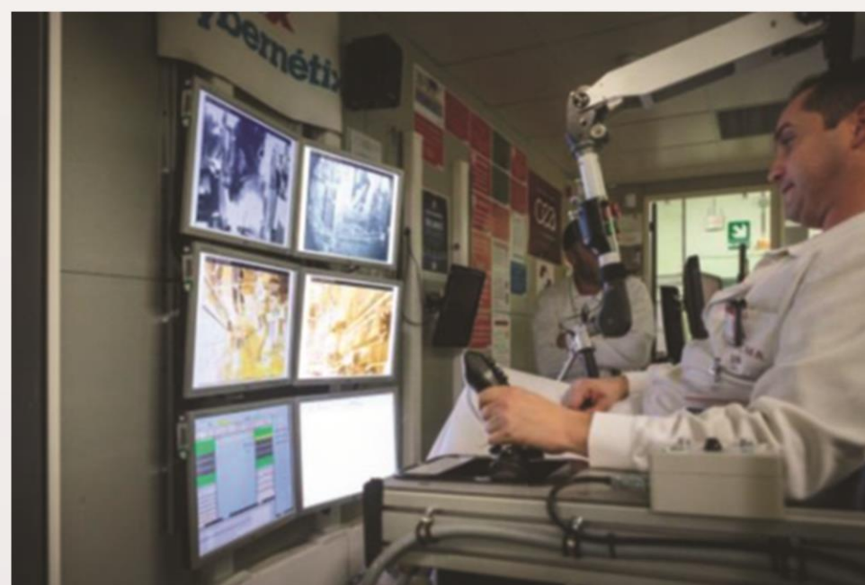
Opérateur aux commandes du bras maître.
