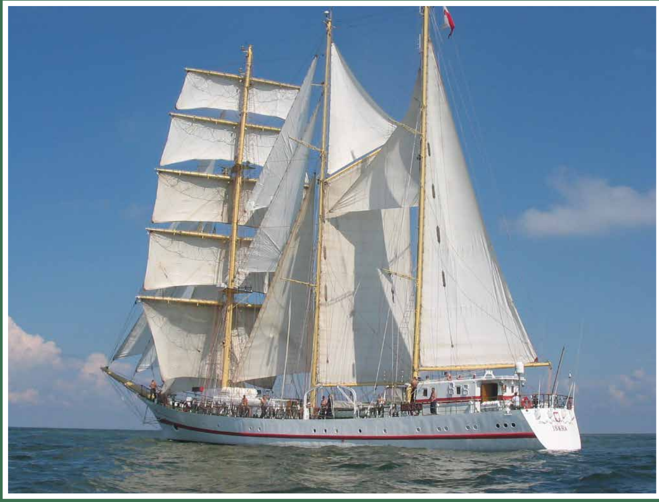
Exemple de voiles variées : ORP Iskra (1982), un trois-mâts goélette gréé avec un phare carré au mât de misaine (avec focs), un gréement à corne sur le grand mât (avec flèche et voiles d'étais) et une voile bermudienne au mât d'artimon (avec voiles d'étais).
